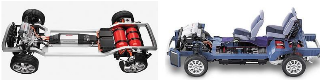
Εικόνα 2 Σχέδιο αμαξώματος με κυψέλη καυσίμου (πηγή Honda).
