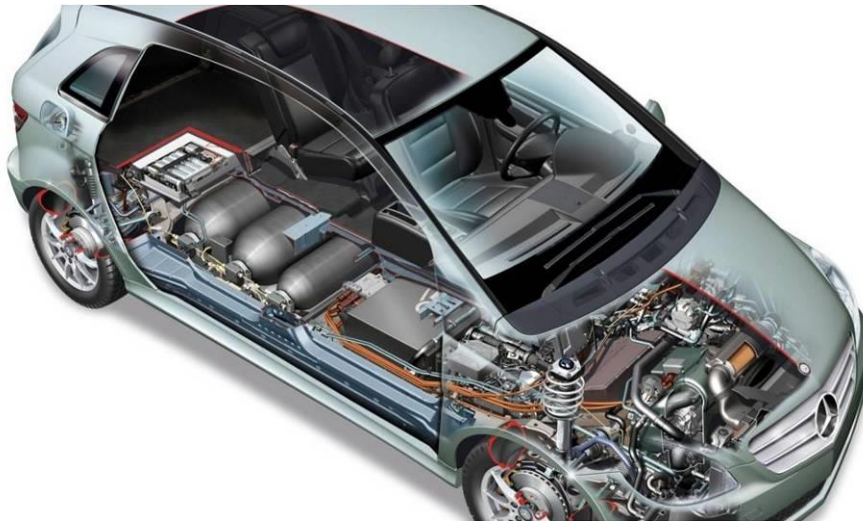
Εικόνα 4 Παράδειγμα συστήματος ισχύος κυψέλης καυσίμου (πηγή Mercedes via EDUCAM)
