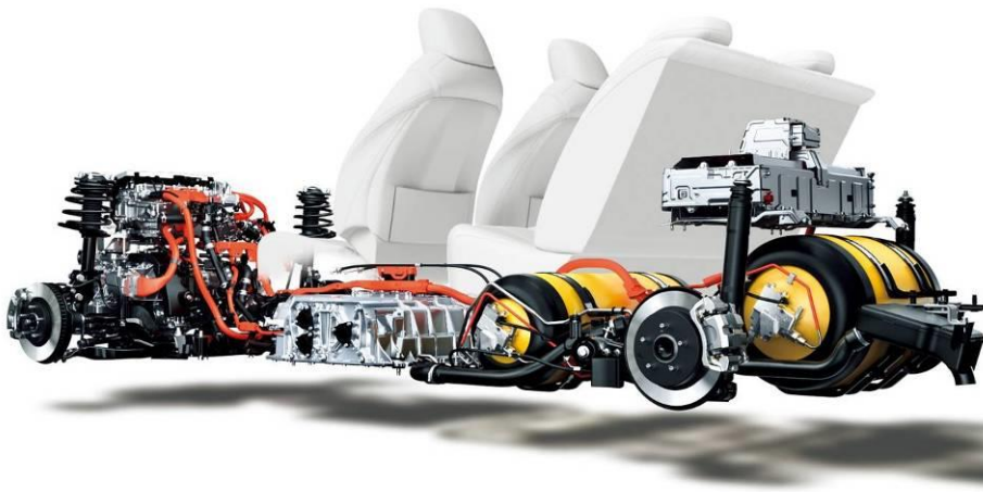
Εικόνα 5 Παράδειγμα συστήματος ισχύος κυψέλης καυσίμου (πηγή Toyota)
