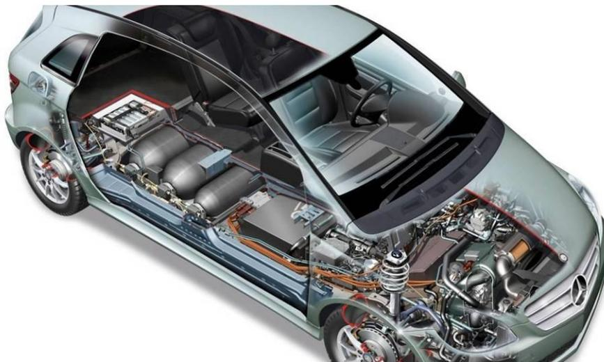
Figure 4: Esempio di un powertrain fuel cell (fonte: Mercedes via EDUCAM)
